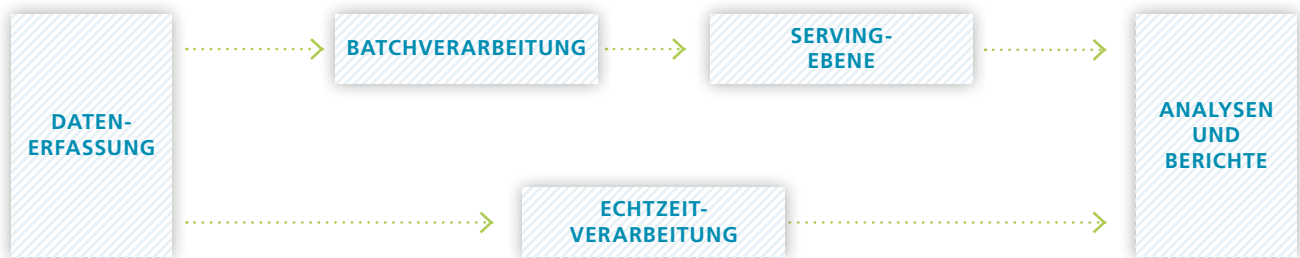
Abbildung 1: Aufbau der Lambda-Architektur (Quelle: seele, O. Zichert)
