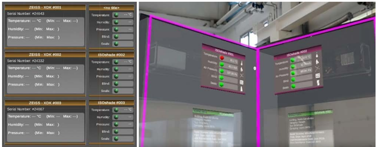
Abbildung 5: Links: Entwickelte Tafeln zur Darstellung der Sensorwerte, rechts: aktive Tafeln mit Sensorzuständen im AR-Raum (Quelle: Fraunhofer HHI)
